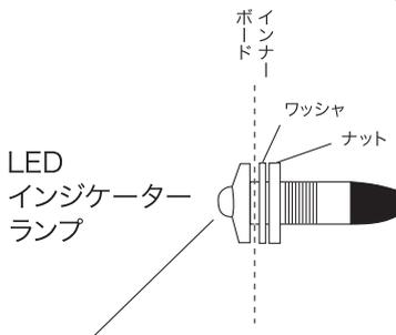
インナーボード(カウル・パネル等)に穴を空け、付属のワッシャ・ナットで挟み、固定します。
